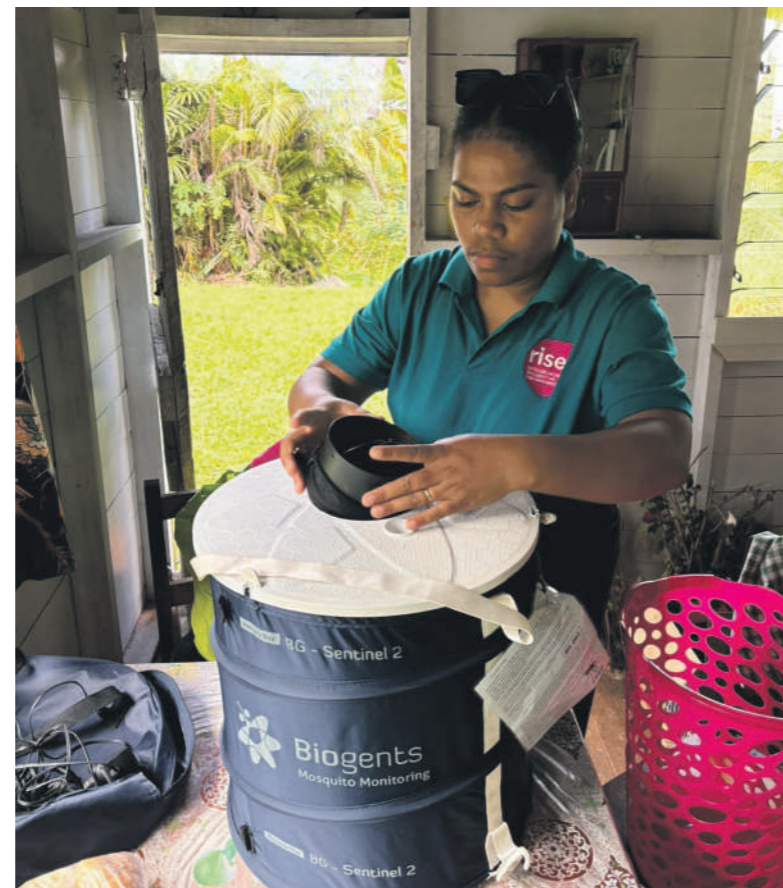
Asisten Peneliti Lapangan, Oni Lewakulati, memasang perangkat BG pada salah satu rumah di Fiji untuk mengumpulkan nyamuk yang akan dianalisis di laboratorium.
