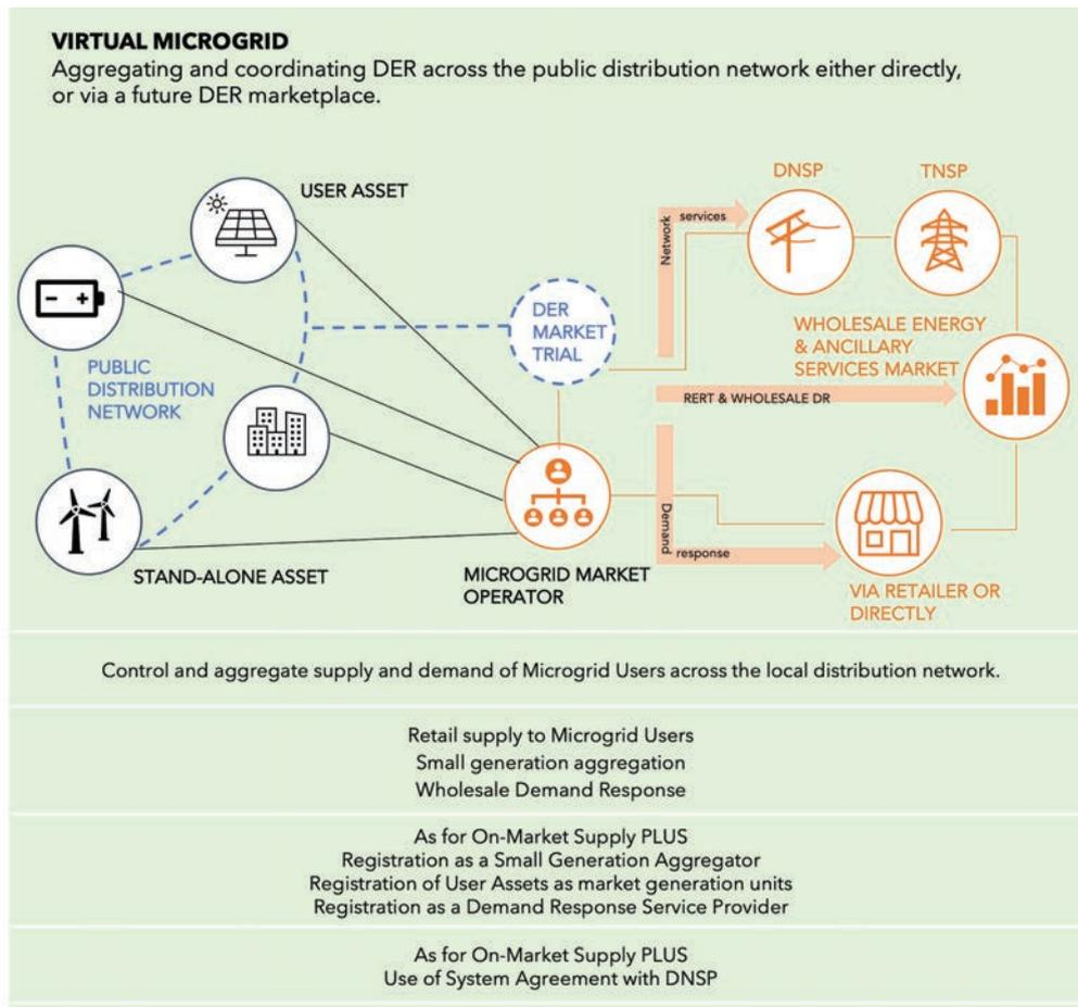
Figure 4 // Virtual microgrid
