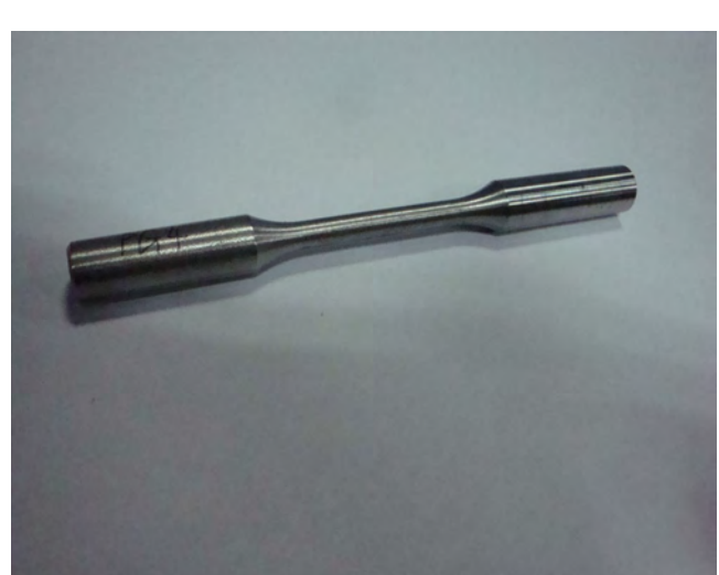
Specimen type 1: Solid specimens (GB/T 228.1-2010)
